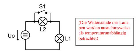
Werte:  $U_0 = 6V$ , Typenangaben für Lampe L1: 6V; 2,4W, Typenangaben für Lampe L2: 2,5V; 0,1A
