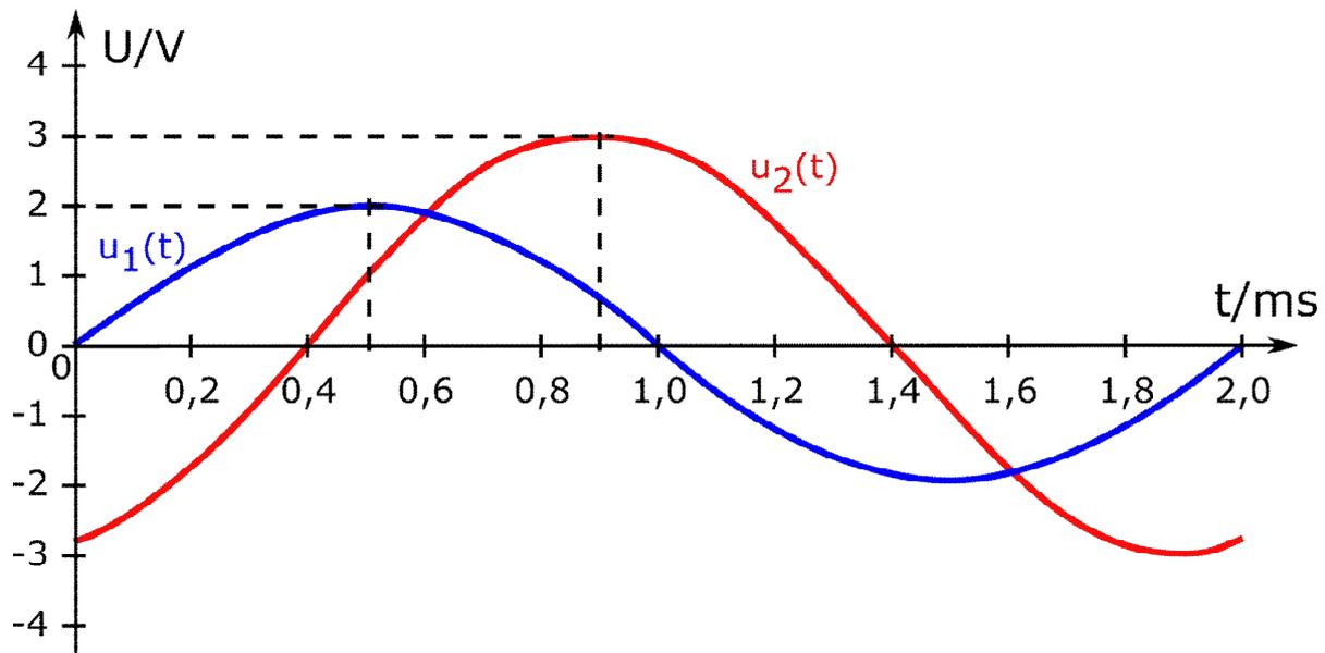
Gegeben seien zwei Spannungsquellen mit den Spannungen  $u_1(t)$  und  $u_2(t)$ , deren Verlauf im Bild dargestellt ist. Die Spannungsquellen werden in Reihe geschaltet.
