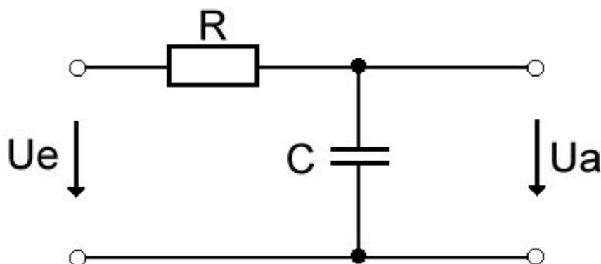
Gegeben sei die obige Schaltung aus Widerstand und Kondensator mit der Eingangsspannung  $U_e = 10V$ .
