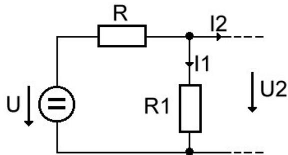
Werte:  $U_2 = 5\text{V}$ ,  $I_2 = 0,5\text{A}$ ,  $R_1 = 2\ \Omega$ ,  $R = 3\ \Omega$ .
