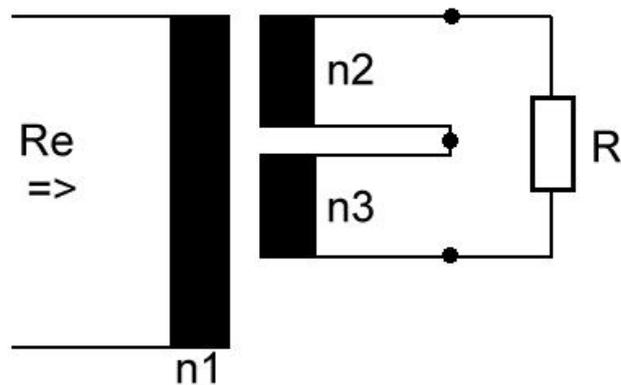
Gegeben sei ein idealer Transformator, der gemäß obigem Bild verschaltet ist. Bestimmen Sie den Eingangswiderstand der Schaltung!
